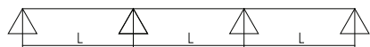
Nosivost krovno fasadni profilisanog lima za četiri oslonca za čelični plastificirani lim (kg/m 2 )
